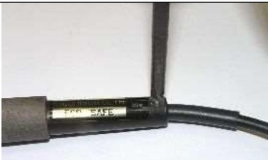
⑯ グリップ端部のセットボルトをプラスドライバーでしめます。
